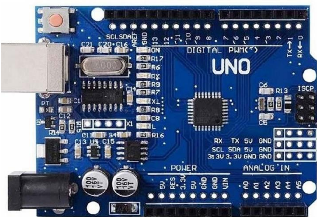
Figura 2: Arduino UNO R3 SMD. Note que o microcontrolador Atmega328 é soldado com um tipo de solda chamada SMD
